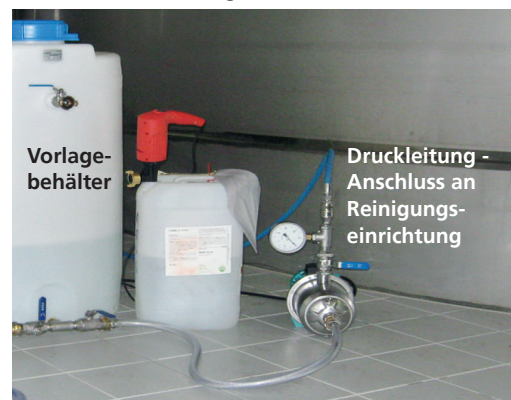
Anwendung von sauren Reinigungsmitteln mittels separater, säurebeständiger Pumpe
